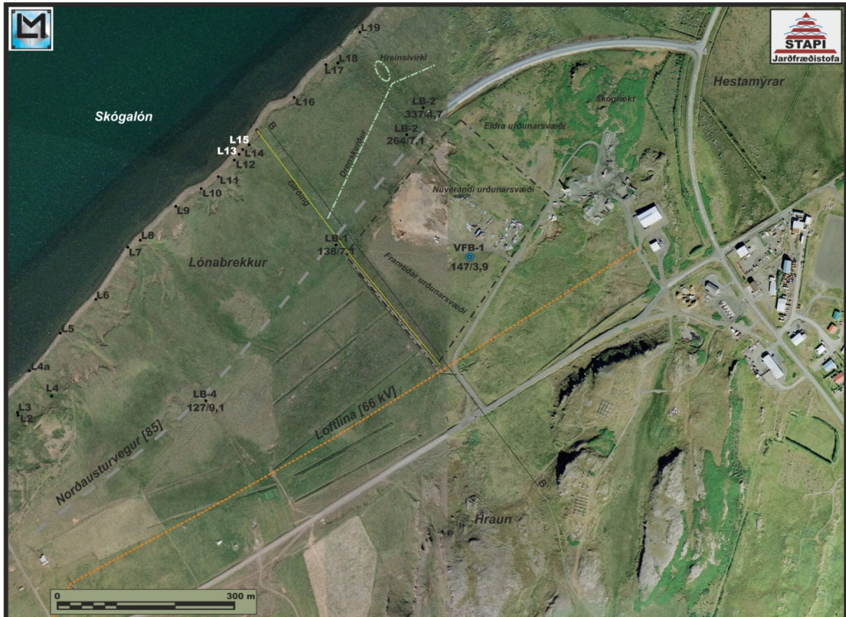
Mynd 25. Yfirlitsmynd af urðunarstaðnum á Búðaröxl og hugsanlegu safnkerfi fyrir sigvatn.
