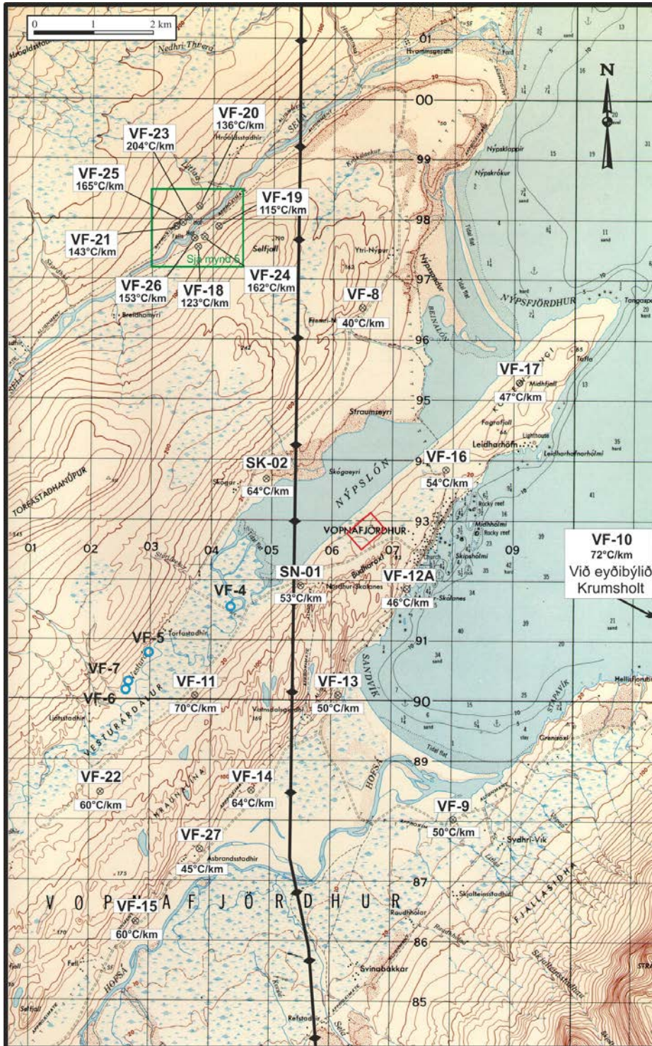
Mynd 6. Staðsetning hitastigulshola í nágrenni Vopnafjarðar sem boraðar höfðu verið fyrir árið 2003. Lega andhverfuássins er sýnd og urðunarstaðurinn á Búðaröxl auðkenndur með rauðum ferhyrningi.
